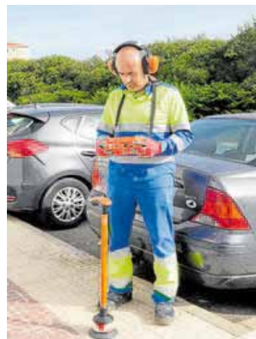
► Uno de los operarios simula cómo sería la búsqueda de averías con el geófono. C. MORENO
